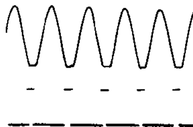
图 6.22 谐振直流环路电压波形(示波图)
