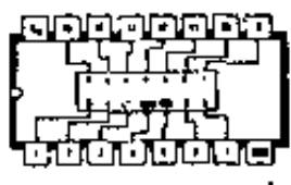
SN 7447 A BCD-7 段译码器/驱动器
