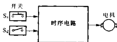
图 3.24 利用开关控制电机的框图
