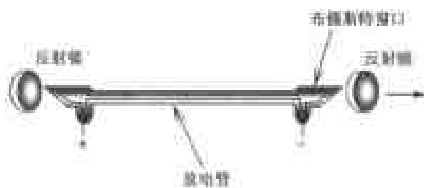
图 4.5 He-Ne 激光器的结构(外部反射镜式)
