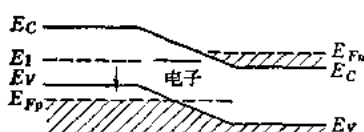
图 3.15 通过能级 E_1 的隧道效应
