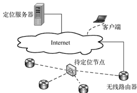
图 5-4 定位实验系统架构示意图
