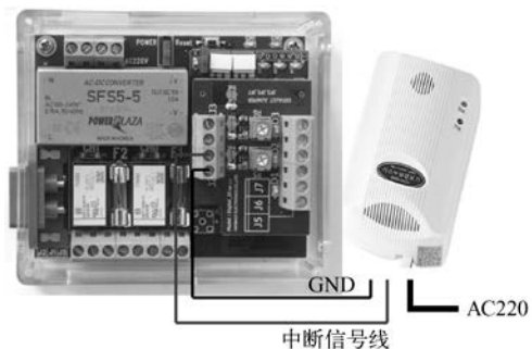
图 6-19 燃气泄漏监测单元连接图
