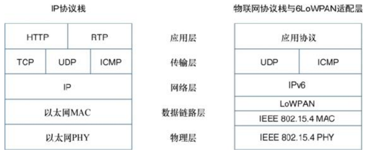
图5-2 利用6LoWPAN和IP协议栈的物联网协议栈比较
