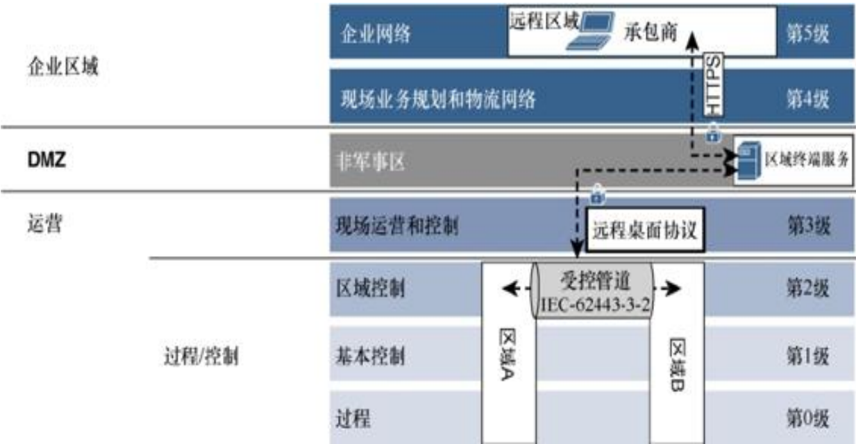
图8-6 在过程控制层次结构模型中级别和区域之间的安全性
