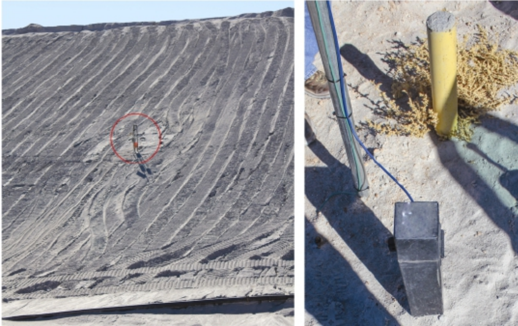
图14-11 带有传感器的尾矿池土坝（左）和压电式地面监测传感器的特写（右）
