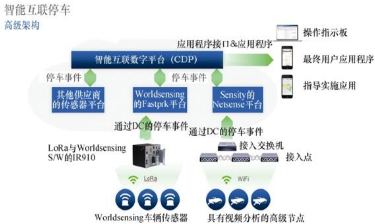
图12-8 互联的停车场架构
