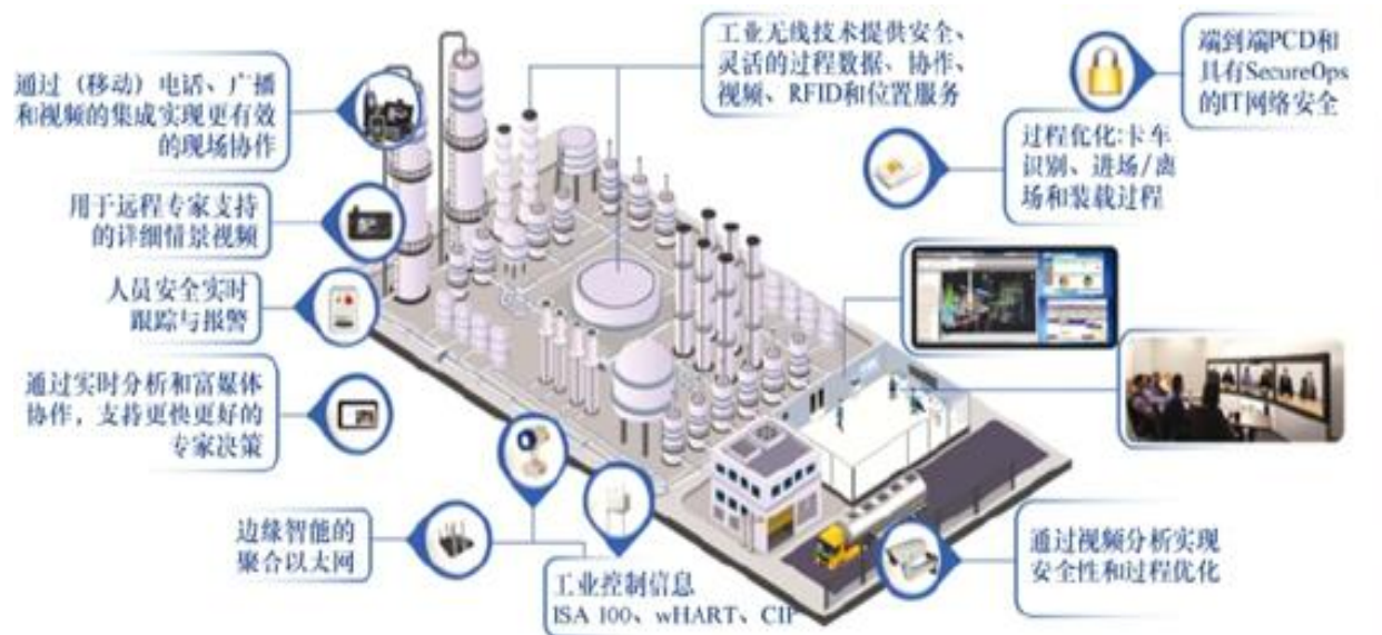
图10-11 连接的炼油厂物联网用例
