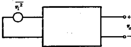
图 11.40 含有等效输入噪声电压发生器的电路
