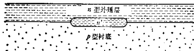
图 2.10 外延生长后的双极型集成电路的晶片
