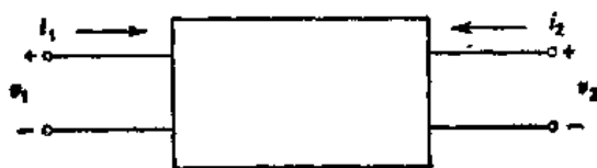
图 8.30 四端网络的 g 参数表示法
