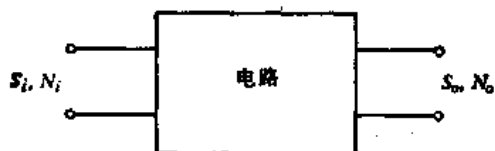
图 11.44 在电路的输入端和输出端上,信号功率和噪声功率
