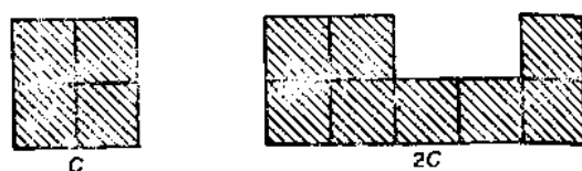
图 5.85 面积和边界尺寸都匹配的电容
