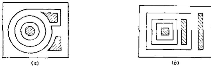
图16-5 横向PNP单管图形
