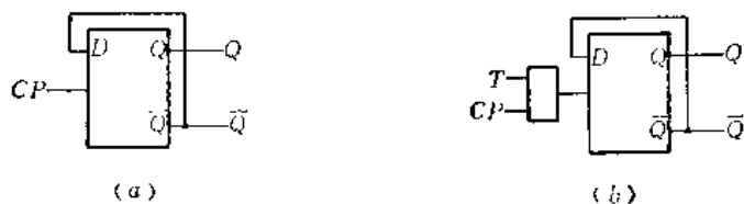
图2-33 D触发器变换成T触发器
