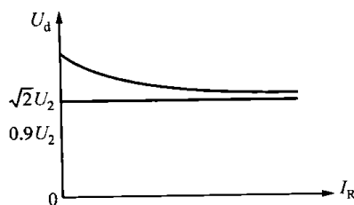
图 6-4 电容滤波的单相不可控整流电路输出电压与输出电流的关系
