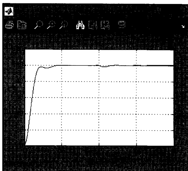
图 7-17 无静差转速单闭环直流调速系统的转速波形
