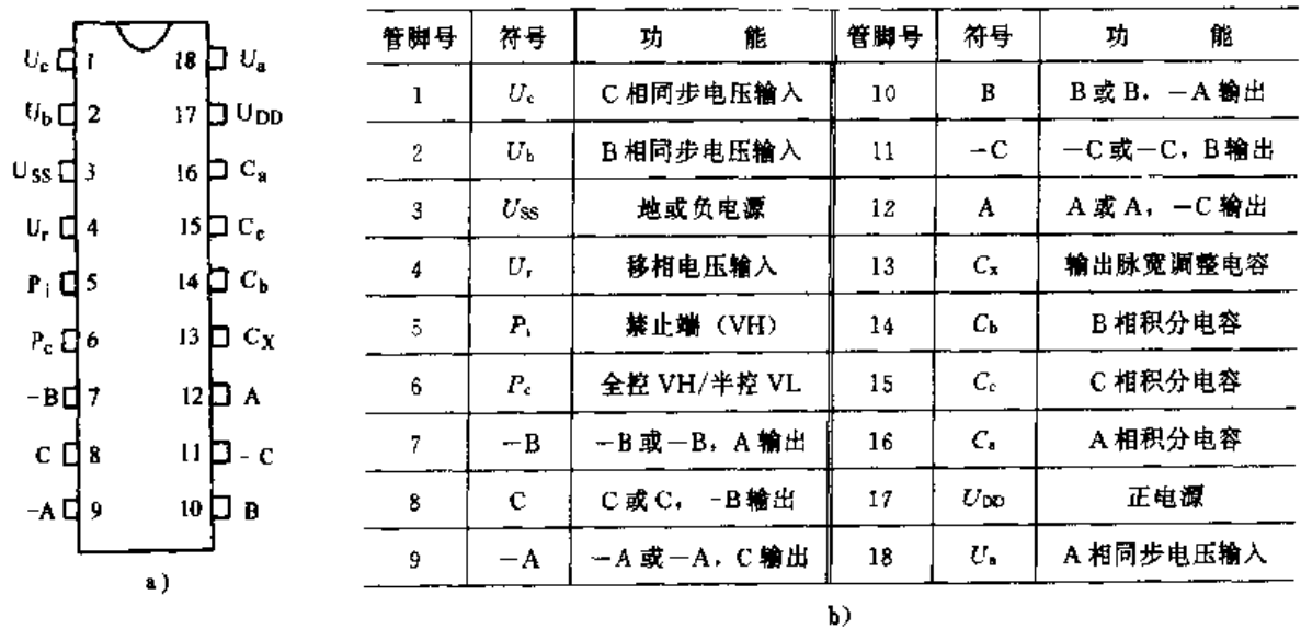
图 12-10 TC787 管脚图及功能表 a) 管脚图 b) 功能表
