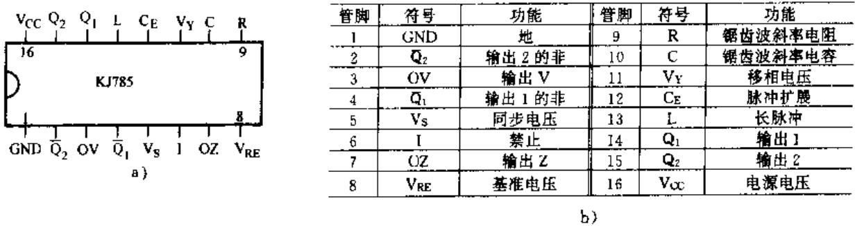
图 16-33 KJ785 管脚功能图
