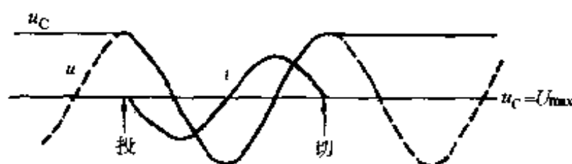
图 2.11 晶闸管投切电容器的投切过程
