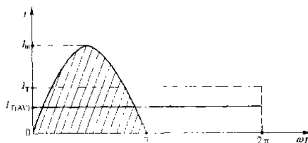
图 1-16 晶闸管通态平均电流 I_{TAV}
